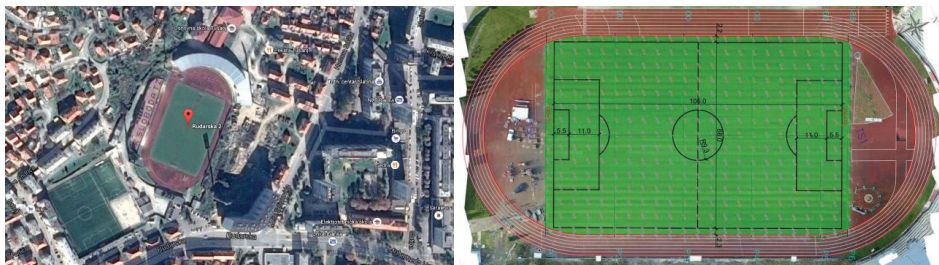
Слика 2: Сателитски снимак стадиона и снимак нултог стања, начињен беспилотном летелицом Phantom 4 pro [6]
