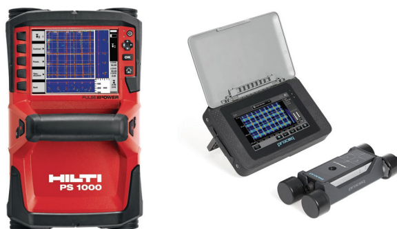
Слика 1: Савремени уређаји за одређивање положаја и пречника арматуре: Hilti Ferrosan PS 1000 и Proceq Profometer 650 AI
