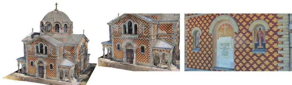
Слика 2: 3Д (меш) модел цркве добијен фотограметријском методом
